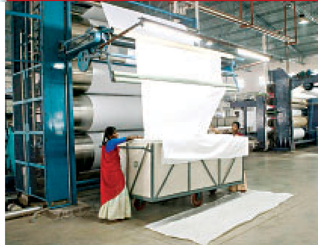
此加工装置每天能够处理 12,500 m 幅宽为 320 cm 的织物。图上显示的是将织物进行干燥的机器。
