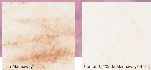
FIG. 3. EFECTO ANTIRREDEPOSICIÓN DE MANNAWAY® SOBRE BARRO DE CANCHA DE TENIS
